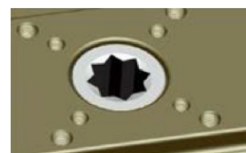
FIGURA 3 - Encaixe padrão ISO 5211
