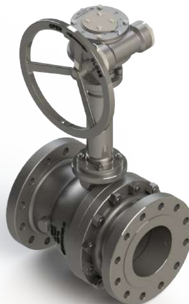
VÁLVULA ESFERA BIPARTIDA SPLIT-BODY BALL VALVE / VÁLVULA ESFERA BIPARTIDA MONTAGEM TRUNNION TRUNNION MOUNTING / MONTAJE TRUNNION ACIONAMENTO MANUAL POR CAIXA DE REDUÇÃO MANUAL OPERATION BY GEARBOX / ACTIVACIÓN MANUAL POR CAJA DE REDUCCIÓN
